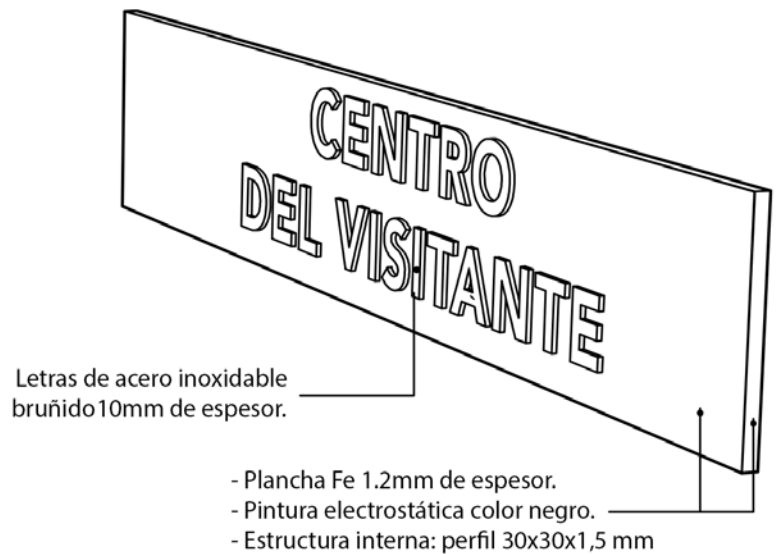
Detalle de construcción:
