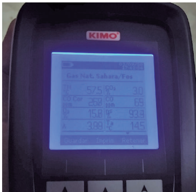
Ilustración 25 - Medición de gases en Sala Térmica
