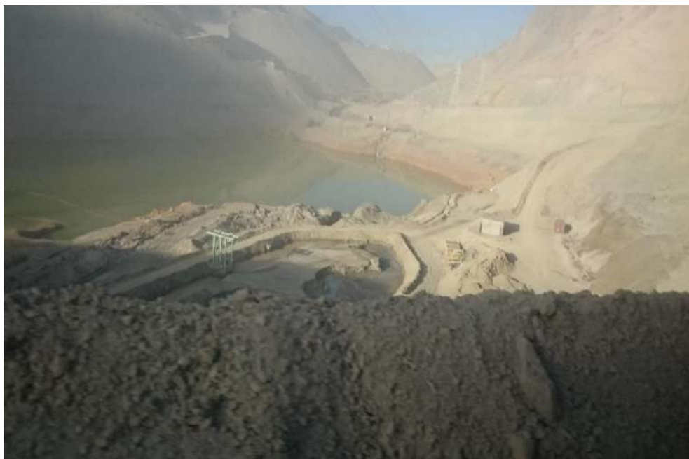
Fig. 8: Nube de polvo fino en la mina Los Bronces generada por circulación de vehículos.
