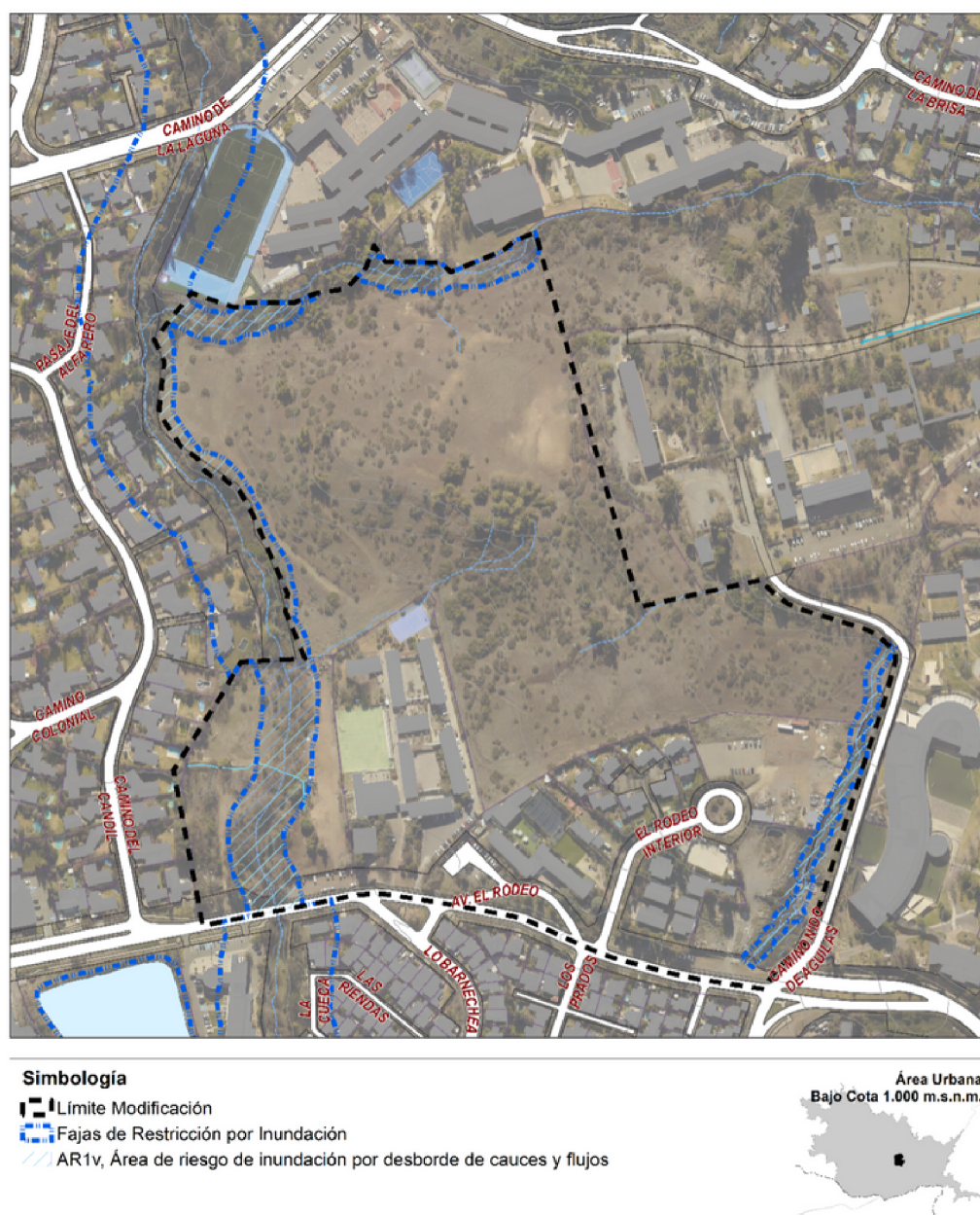
Ilustración 10.- AR1v, Área de riesgo de inundación por desborde de cauces y flujos en sector sujeto a modificación
