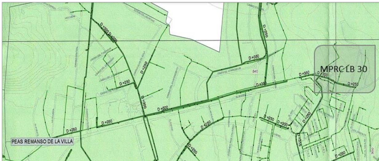
Ilustración 6-6: Infraestructura de alcantarillado de aguas servidas existente en la zona MPRC-LB-30.
