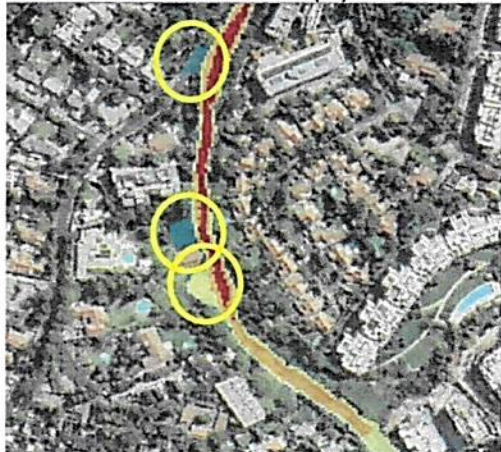
Figura 8.64 Zona de desborde 3 estero Las Hualtatas sur (t2)
