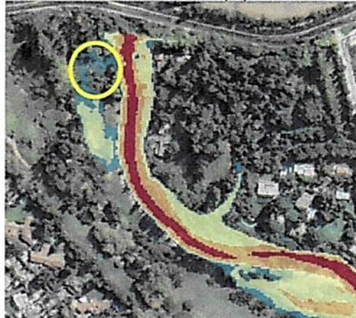
Figura 8.62 Zona de desborde 2 estero Las Hualtatas sur (t2)
