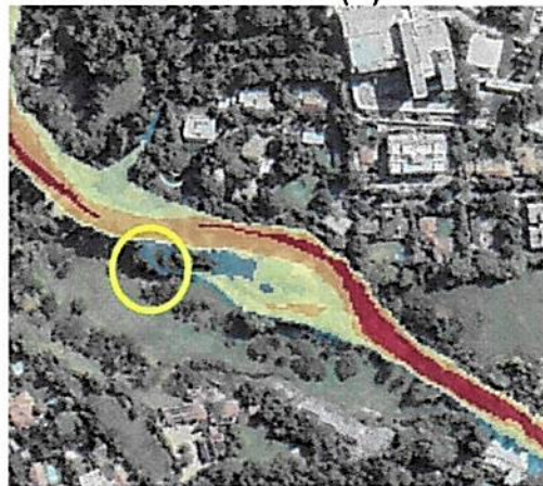
Figura 8.60 Zona de desborde 1 estero Las Hualtatas sur (t2)
