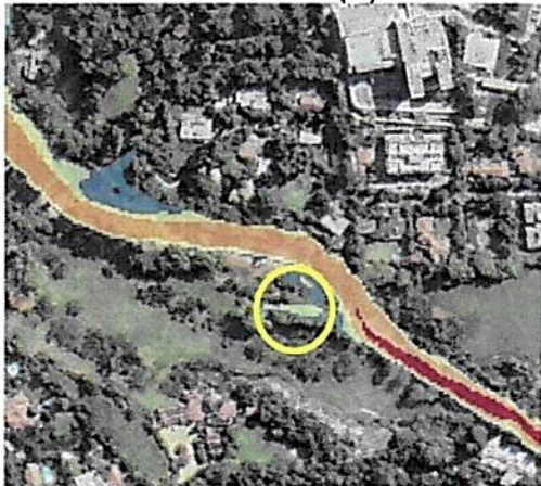
Figura 8.59 Zona de desborde 1 estero Las Hualtatas sur (t1)
