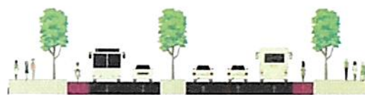
Situación proyectada Ciclovía unidireccional por los costados
