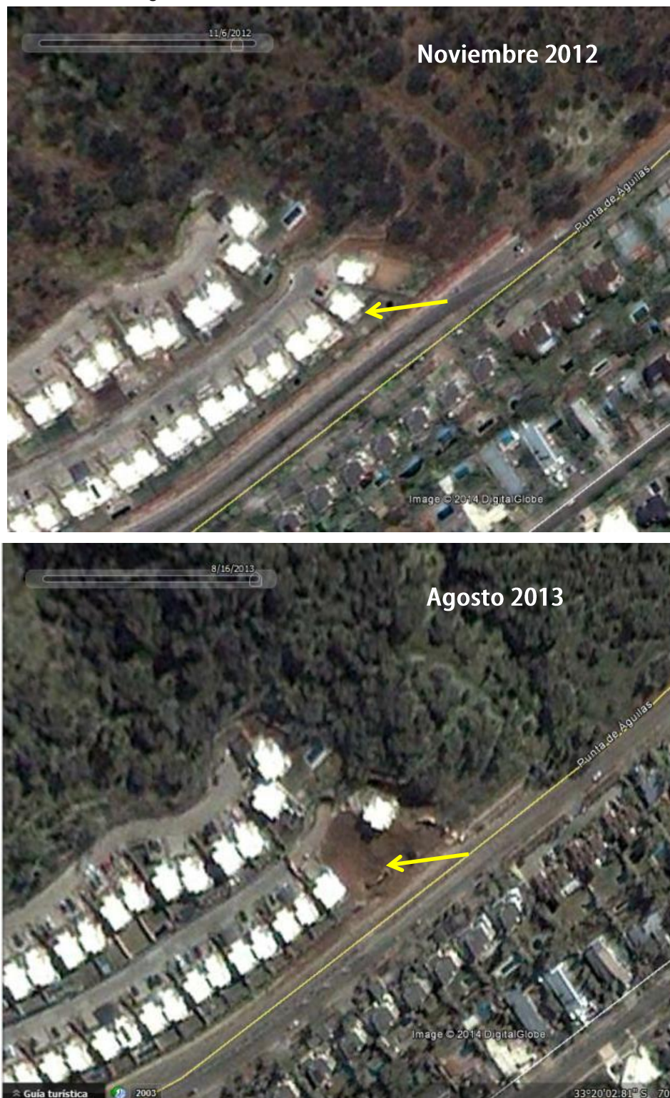
FIGURA N° 4-8 Imagen satelital que muestra sector afectado por deslizamiento del año 2013 en Camino Punta de Águilas. La flecha amarilla indica ubicación de la vivienda afectada.
